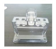
防漏制胶垫:制胶不漏胶,制出胶底部平整。
